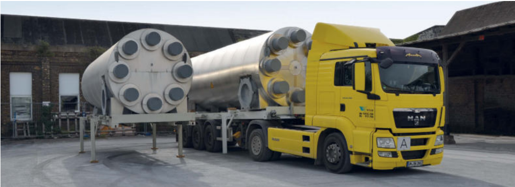
Mobile Sorptionsspeicher können Wärme speichern und transportieren, sodass Bereitstellung und Nutzung örtlich entkoppelt sind. Das Bild zeigt den Wechsel der Speicher-Container beim Wärmeabnehmer. © ZAE Bayern
