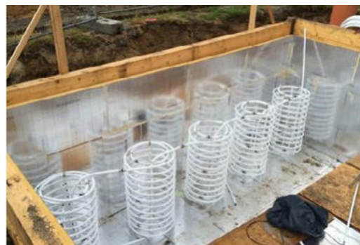
Abbildung 5 Wärmespeicherung in wassergesättigten porösen zement- basierten Materialien (UFZ)
