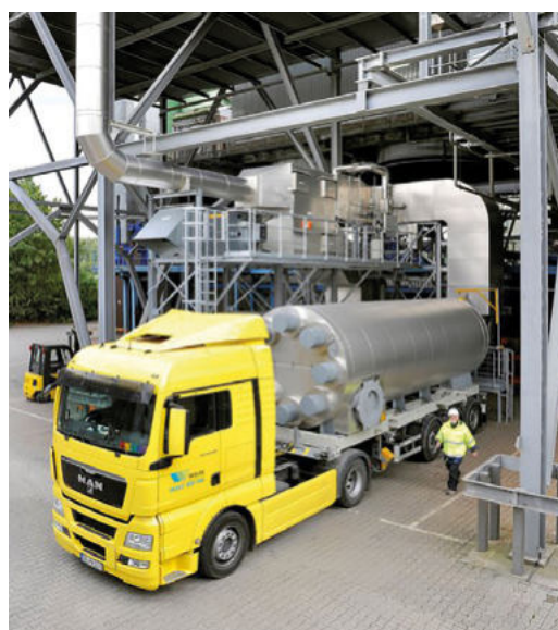
Abbildung 7 mobiler Sorptionspeicher zur Nutzung industrieller Abwärme (ZAE Bayern)
