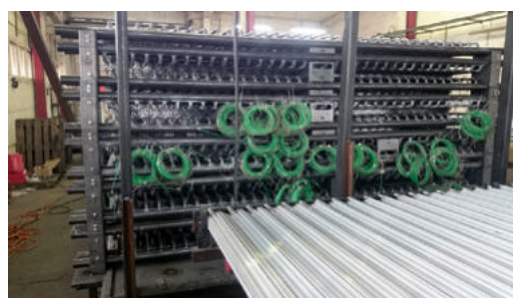
Abbildung 8 Wärmeübertrager für Hochleistungs-Latentwärmespeicher (DLR)
