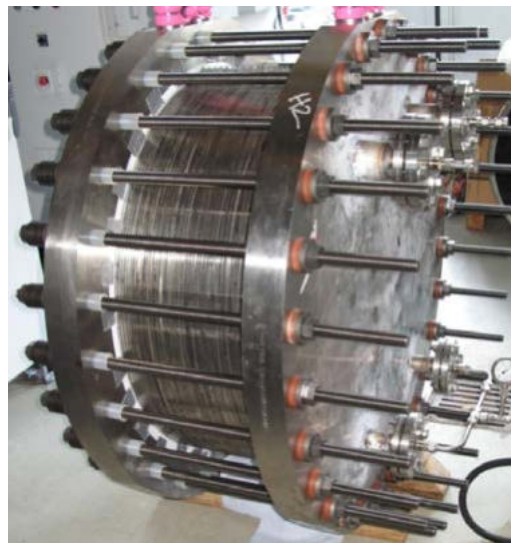
Abbildung 3 24-zelliger Elektrolyseblock (Quelle: ZSW)
