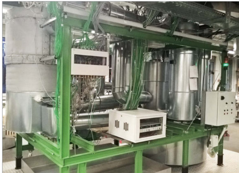
Abbildung 3 Ein-Tank-Speicherteststand für Salzschnmelzen des Fraunhofer ISE. Eine sehr gute Schichtung der Salzschnmelze im Speicher (links im Bild) konnte erfolgreich nachgewiesen werden. Quelle Fraunhofer ISE
