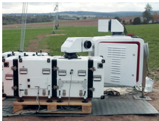
Abbildung 1 LiDAR-Scanner (links) und Messaufbau mit mehreren Multi-LiDAR- Systemen (rechts) für das Kassel- Experiment im euro- päischen Vorhaben „Neuer Europäischer Windatlas“ (NEWA) [Quelle: Fraunhofer IWES, Kassel]
