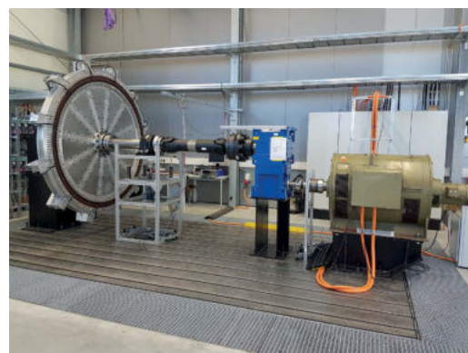
Abbildung 3 Magnetrings-Generator im Labormaßstab (176 kW) [Quelle: Fraunhofer IWES, Kassel]
