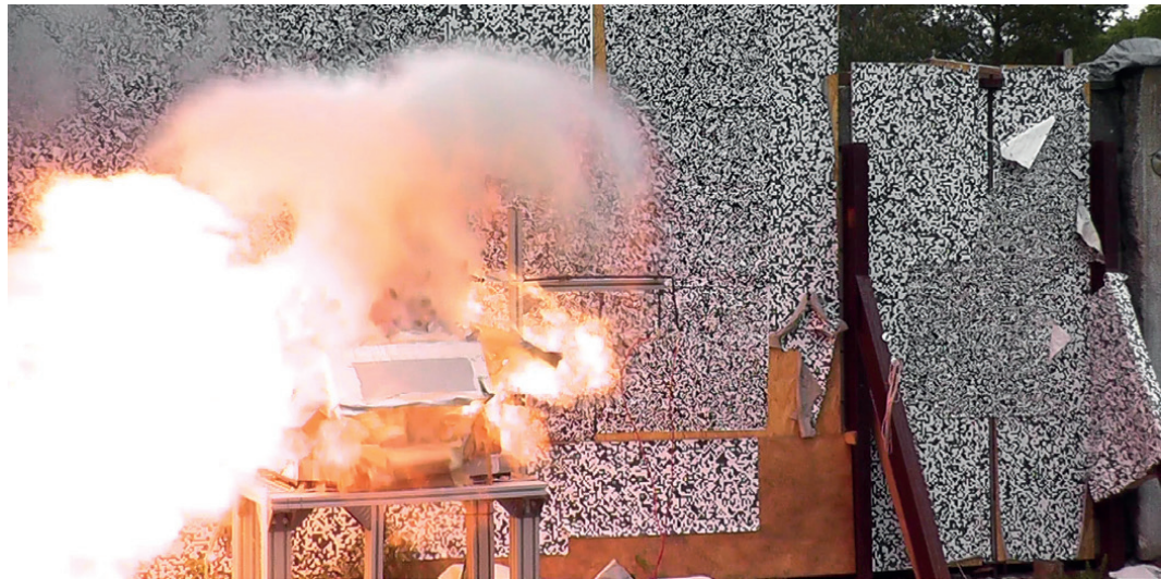
Abbildung 2 Projekt PRESLHY: KIT E4.4 Pool- Experiment mit Zündung über Kiesbett
