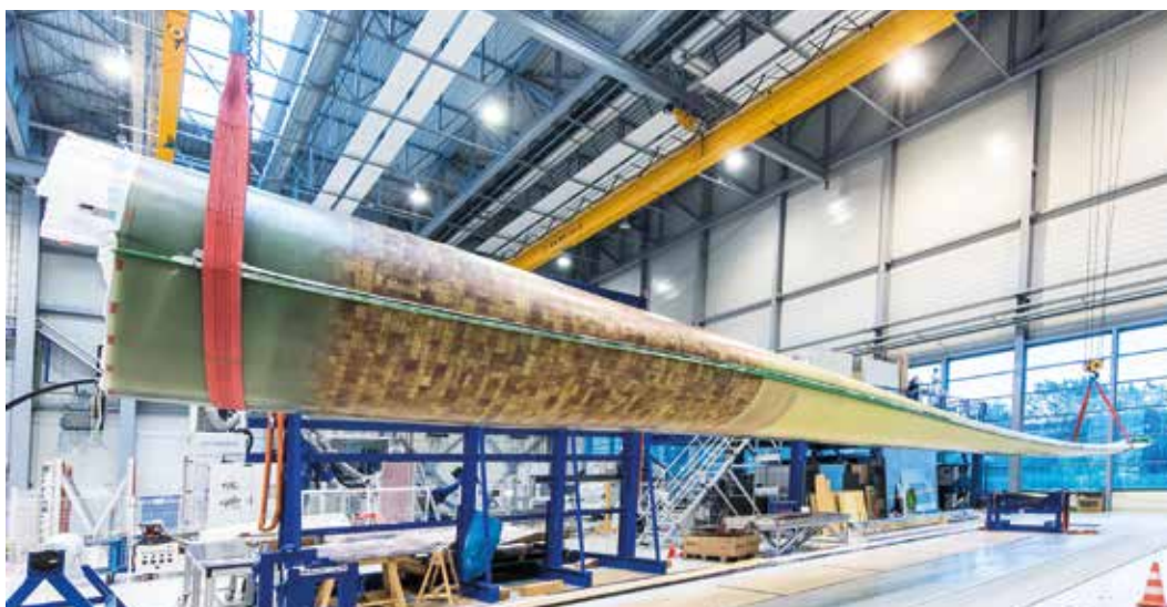
Abbildung 8 Fertigung eines Testrotorblattes im Projekt SmartBlades 2 Quelle: IWES
