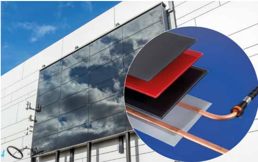
Abbildung 2 Testanlage einer solaraktiven Glasfassade und exemplarischer Modulaufbau [©ISFH]
