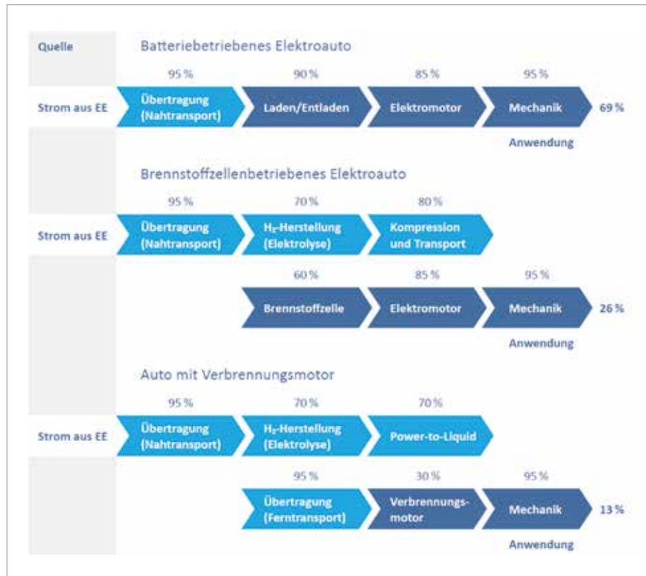
Abbildung 2: Gesamt-Energieeffizienz von Pkw mit verschiedenen Antriebskonzepten, die alle auf Strom aus erneuerbaren Energien basieren [2]
