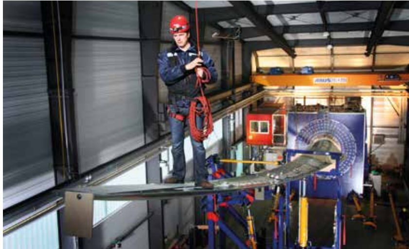
Abbildung 6 Beispiel für eine Blattprüfung Quelle: IWES
