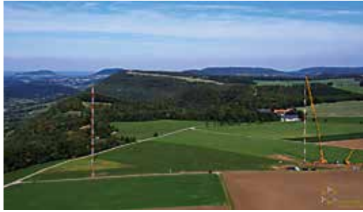
Abbildung 2 Zwei meteorologische Messmasten des WindForS-Forschungstestfelds am Albtrauf bei Geislingen/Donzdorf Quelle: WindForS
