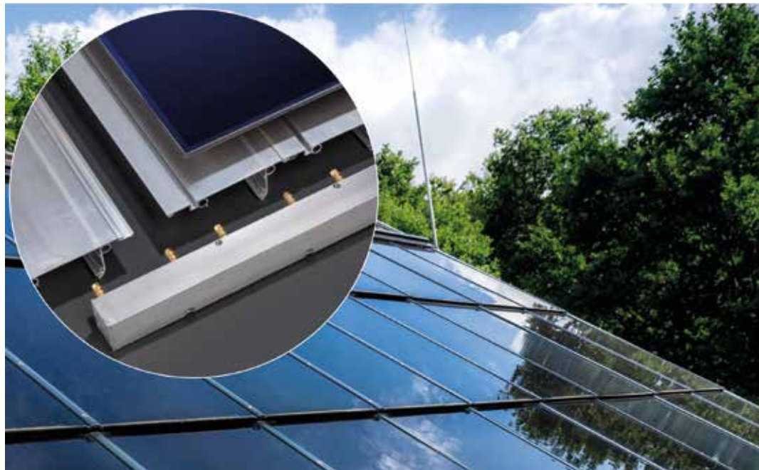
Abbildung 1 PVT-Testanlage und Aufbau eines PVT- Prototypes [©ISFH]
